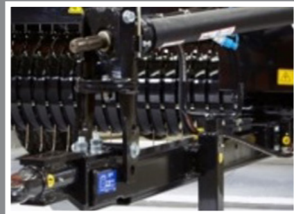
Şaft sabitleyicisi ile daha kolay şaft bağlantısı
