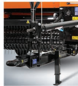
2 Şaft sabitleyicisi ile daha kolay şaft bağlantısı.
