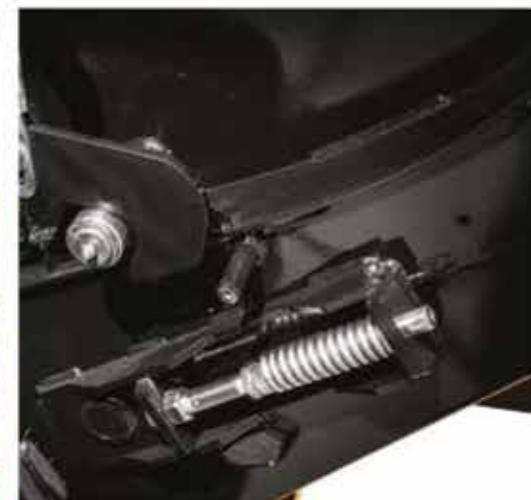
Balyaların sarım işlemi sırasında yeterli yoğunluğa ulaşmasını sağlayan ve ulaşığında sizi bilgilendirmek için elektronik sistemi uyaracak şekilde tasarlanmış gergi mekanizması bulunmaktadır.
