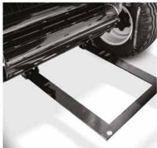
Balyaların makineden çıkarken yere yumuşak bir şekilde bırakılabilmesi için balya tutucu standart olarak bulunmaktadır.
