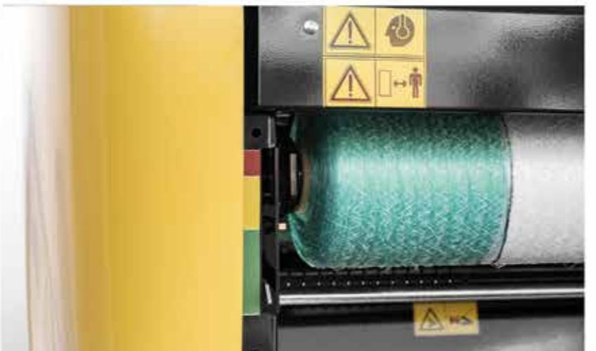
File, makinenin önündeki kapağının altına yerleştirilir. Kolayca ulaşarak sökme/takma yapılmaktadır. Tüm BR modellerinde, yeni bir file eklemek için hiç bir aparat ihtiyaç duymadan hızlı ve kolay yapılmaktadır.
